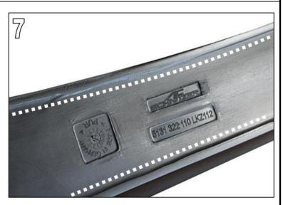
Placez le becquet de toit arrière AC Schnitzer sur la lunette arrière du véhicule, alignez-le avec précision, appuyez fermement et fixez-le avec du ruban adhésif et des aides au montage.
